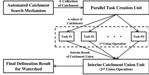
Fig. 5. Parallel-Union subsystem.
